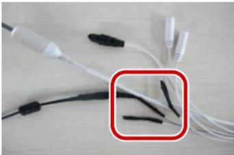
4. Обмотайте все ответвительные кабели изоляционной лентой.
