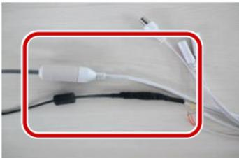
3. Обмотайте остальные кабели изоляционной лентой.
