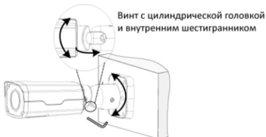
Ослабьте два винта с цилиндрической головкой и внутренним шестигранником с помощью Г-образного шестигранного ключа №4 (приобретается отдельно) во избежание повреждения универсального шарнирного соединения. Затем поверните камеру в желаемом направлении наблюдения. В завершении монтажа затяните винты.
