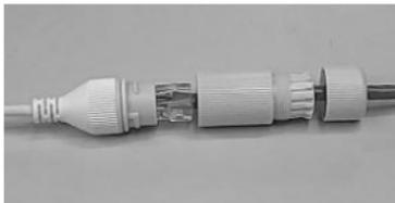
5. Закрутите водонепроницаемый колпачок болта.
