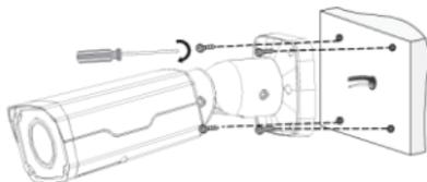
Вставьте саморезы в направляющие отверстия, расположенные в основании, и закрутите их в стену отверткой.
